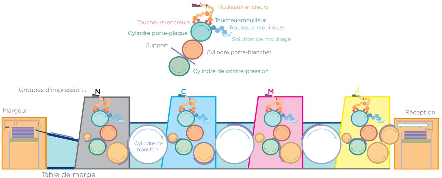
L'impression offset repose sur la répulsion eau/corps gras qui se passe sur la plaque d'aluminium gravée par le CTP
